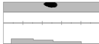
Το ίδιο παχύ σκουριασμένο σιδερένιο μπουλόνι ελέγχθηκε από διαφορετική κατεύθυνση, δείχνοντας πιο καθαρά ότι είναι σιδηρούχο.
